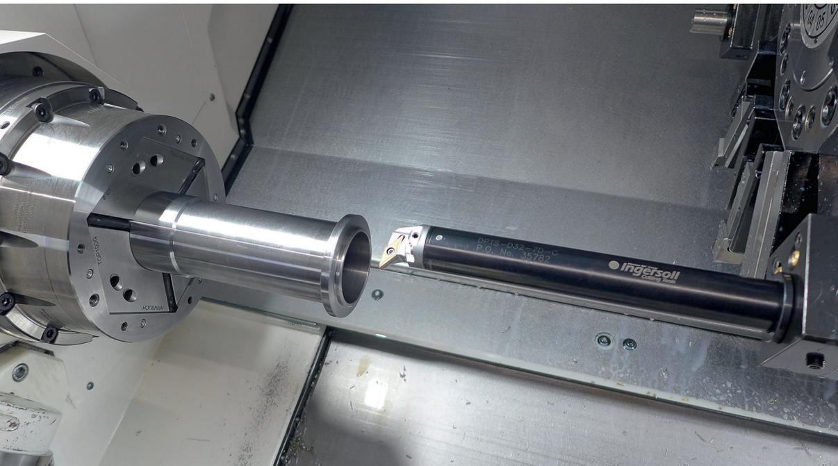
1 Wenn, wie hier bei ZTS-Zerspanungstechnik Stadler, 300 mm lange Bohrungen in Hohlwellen aus hochfester Alu-Knetlegierung eingebracht werden, bewähren sich Bohrstanzen der Baureihe T-Absorber von Ingersoll Werkzeuge
