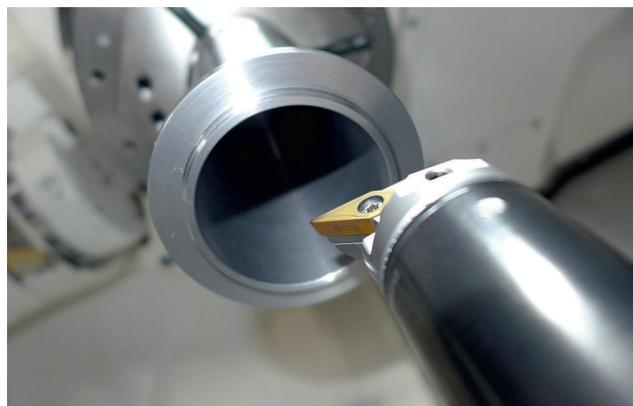
2 In der Bohrung wird die geforderte Oberflächengüte  $R_z 16 \mu\text{m}$  aufgrund des vibrationsfreien Schnitts der Spezialbohrstanze erreicht und sogar unterboten
